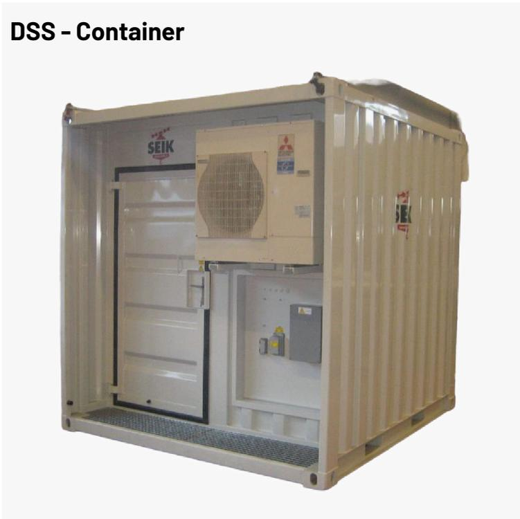
Bei einem möglichen Anschluss an das Stromnetz wird die Winde an einen klimatisierten Container angeschlossen, der mit einem Wechselrichter und einer programmierbaren Steuerung ausgestattet ist. In dieser Konfiguration kann die potenzielle Bremsenergie der abwärts bewegten Lasten in elektrische Energie umgewandelt und wieder in das Netz eingespeist werden.
