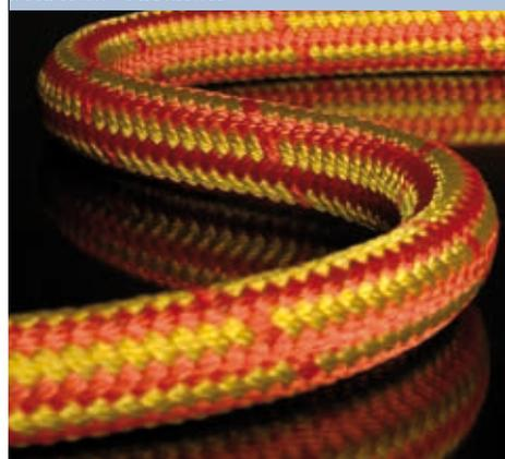
STRATOS Anchor è una fune tessile per l'utilizzo sulle torrette. La costruzione speciale della fune assicura, grazie all'intrecciato ad alta densità, una protezione del mantello dall'abrasione e dai raggi UV. Il nucleo rinforzato in Dyneema garantisce un carico di rottura comparabile a quello di una fune in acciaio, ma con l'80% in meno del peso.
