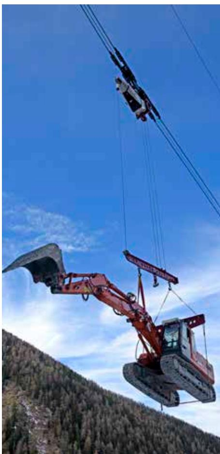
In particolare per la silvicoltura proponiamo impianti azionabili da due operatori, o addirittura da un operatore solo, che permettono un lavoro razionale ed un'alta produttività. Il nostro sistema protegge le funi in maniera eccezionale, perché il carrello lavora anche con un'inclinazione di quasi 90 gradi e senza bloccaggio della fune traente, mentre per il sollevamento dei carichi si impiega un cavo di sollevamento separato. Il cavo di trazione sposta invece solamente il carrello.
